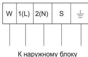
Клеммы для подключения проводов на наружном блоке
