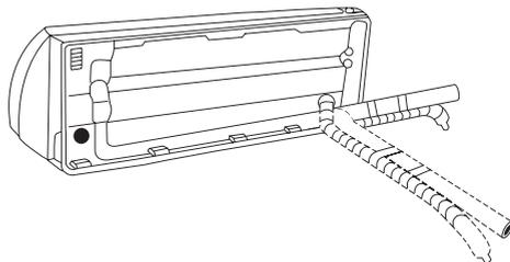
Будьте крайне осторожны, чтобы не погнуть (заломать) трубопровод при изгибе его от блока. Любые повреждения трубопровода влияют на рабочие характеристики установки.
