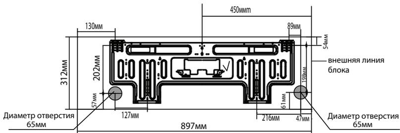
Если соединительная труба со стороны газа имеет  $\varnothing 16$  мм или более, отверстие в стене должно быть  $\varnothing 90$  мм.
