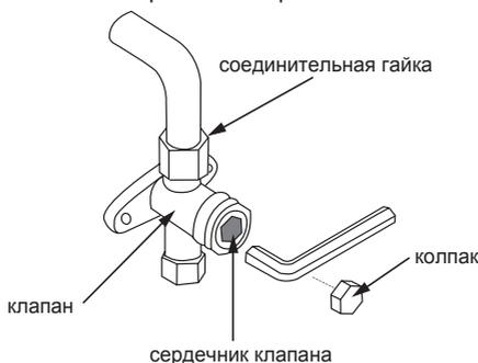
При повторной установке (перемонтаже) блока, а также при наличии влаги, рекомендуем более длительное вакуумирование.
