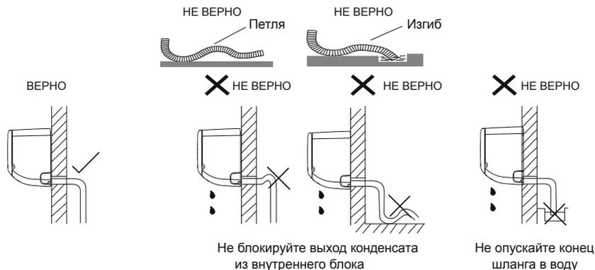
При удлинении дренажной трубы надежно закрепите и изолируйте место соединения, не допускайте того, чтобы дренажная труба болталась.
