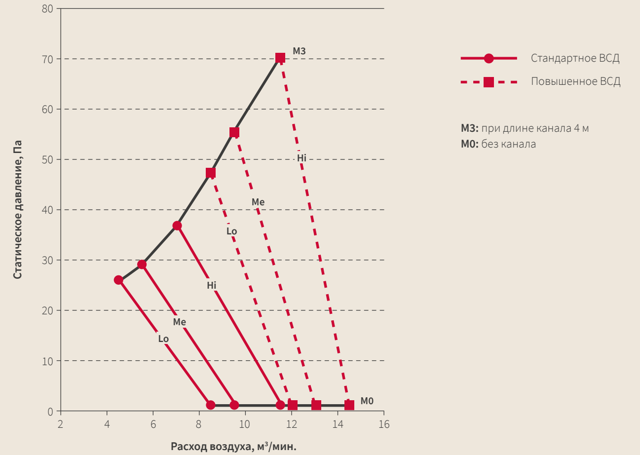
Внешнее статическое давление канальных блоков RAD-50RPE, RAD-60RPE, RAD-70PPD
